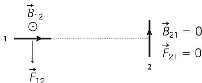
Figura XXII.2: Forças entre elementos de corrente segundo Biot & Savart (adaptado de TRICKER, 1965, op. cit., nota 152).
