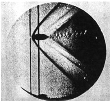
Imagem de uma bala supersônica, formando ondas de choque, obtida por Mach (1887) por meio da técnica “schlieren”.
