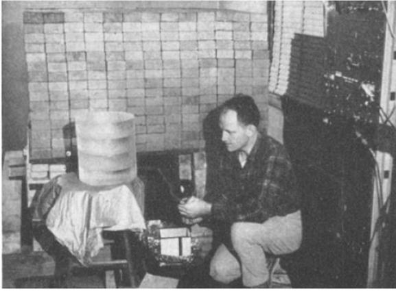
Fig. 5. James Smith manuseia a fotomultiplicadora, a ser colocada abaixo do cintilador, de formato cilíndrico. Ao fundo veem-se os tijolos de ferro, embaixo do qual seria colocado o detector.
